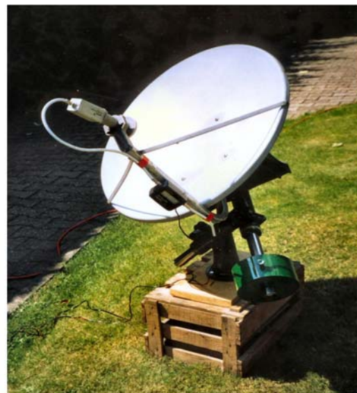
Abb. 2 Parallaxische Montierung der Antennenschüssel
