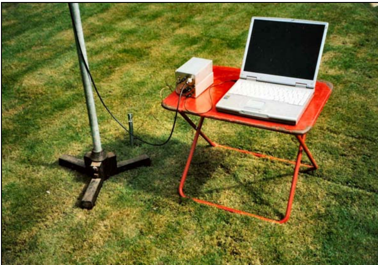
Abb. 4 Empfänger und Computer, Probeaufbau. Im späteren Einsatz war der Empfänger unterhalb der Antenne am Mast angebracht und ohne Kabel mit dem Antennenfußpunkt verbunden
