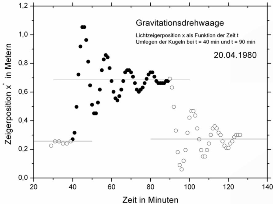
Abb. 5 Endausschlagmethode. Gemessen wird der Unterschied  $\Delta x^*$  der durch die horizontalen Linien angedeuteten Zeigerpositionen. Sie entsprechen den Positionen im jeweils eingependelten Zustand. Gemessen wird  $\Delta x^* = (0,420 \pm 0,024)$  m.
