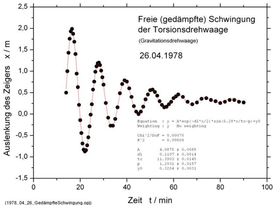
Abb. 2 Schwingung der Gravitationsdrehwaage
