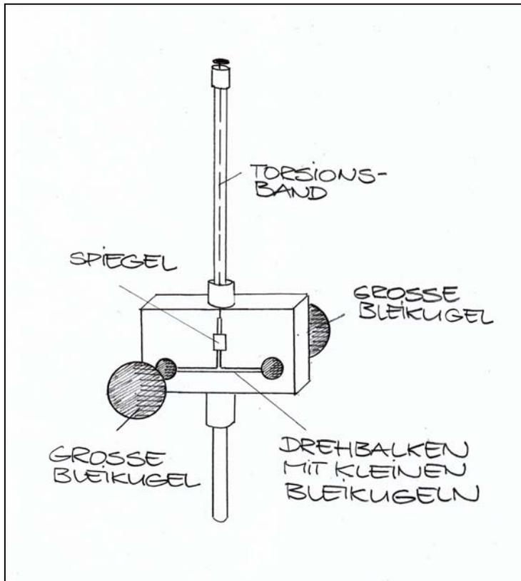
Abb. 1 Torsionswaage mit Bleikugeln
