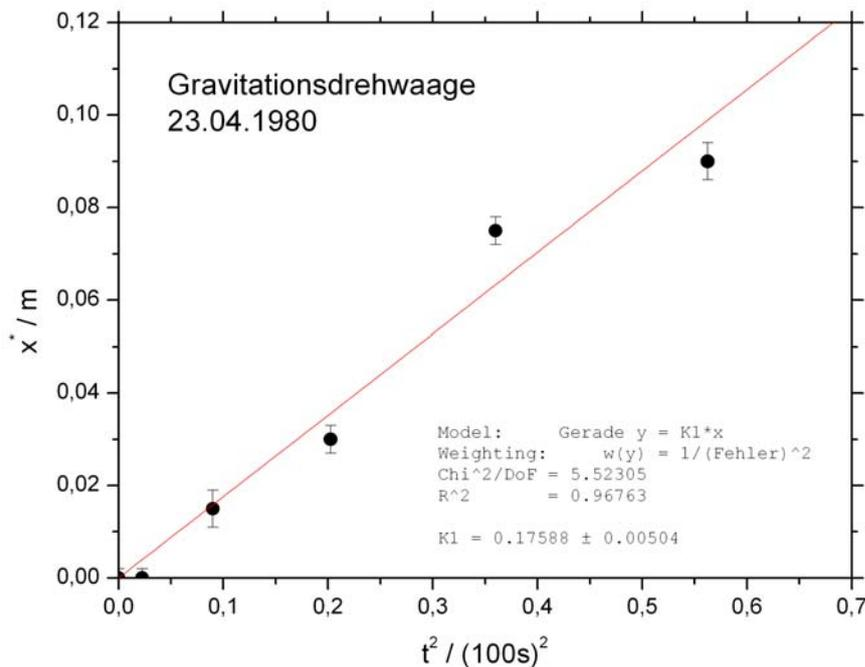
Abb. 4 Beschleunigungsmethode. Messwert ist die Steigung  $K_1$  der Geraden. Die Anpassung ergibt  $K_1 = (1,76 \pm 0,16) \cdot 10^{-5} \text{ m/s}^2$ . Daraus folgt für die Beschleunigung  $a = (8,19 \pm 0,74) \cdot 10^{-8} \text{ m/s}^2$
