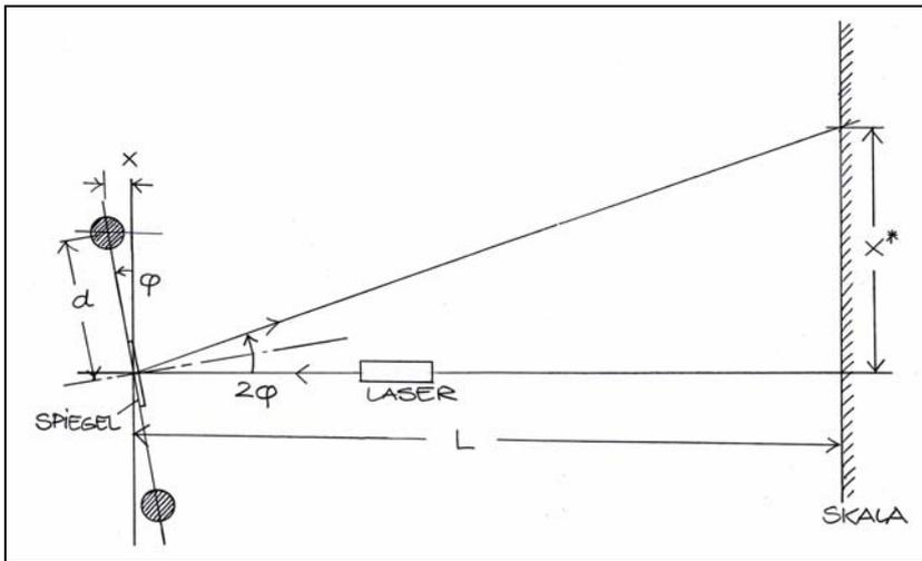
Abb. 3 Geometrie der Lichtzeigeranordnung
