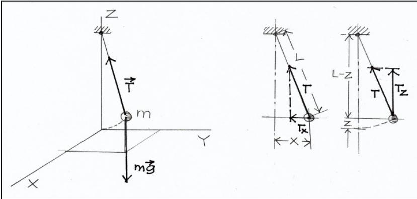
Abb. 2 Zerlegung der Zugkraft  $T$  in Komponenten
