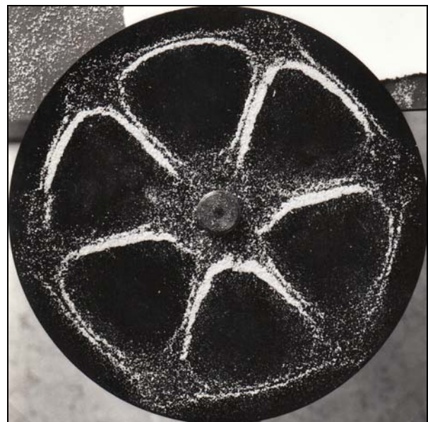
Abb. 4 Chladni-Figur auf kreisförmiger Platte, f = 2000 \text{ Hz} , Foto: Holger Mönch
