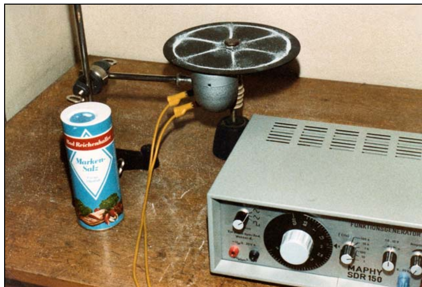
Abb. 2 Versuchsaufbau. Um die Knotenlinie besser sichtbar zu machen, wurde weißes Salz an Stelle von Sand auf die Platte gestreut
