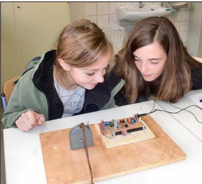
Station 8: Funkpeilen des Zeitzeichensenders DCF77. Zeigt die Ferritantenne des Empfängers (schwarzer Stab auf der hellen Platine) in Richtung des Senders, ist das Signal schwach, senkrecht dazu stark. Das graue Gerät auf der Holzplatte ist ein (Magnet-)kompass.
